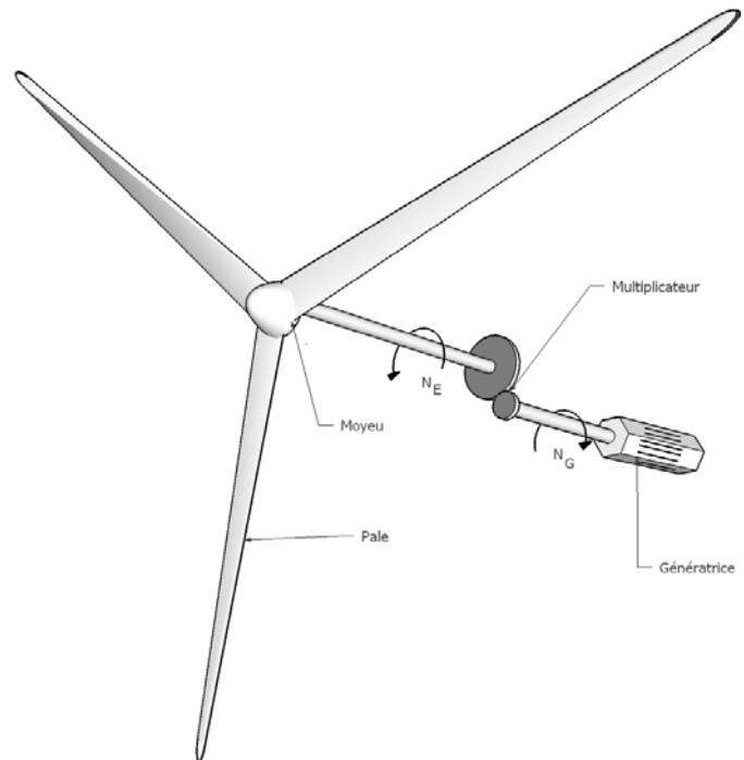
**II-1-** Compléter la chaîne énergétique illustrant la conversion d'énergie en portant sur les flèches le type d'énergie impliqué (mécanique, électrique, chaleur).
