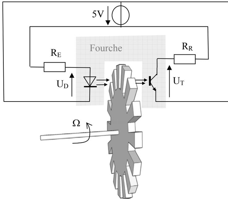
**III-1-** Quelles sont les grandeurs d'entrée et de sortie de la fourche optique ?
